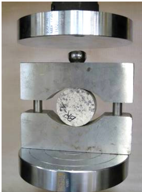
13. ábra: hasító vizsgálat ( http://www.geotechdata.info/geotest/brazilian-test.html )
