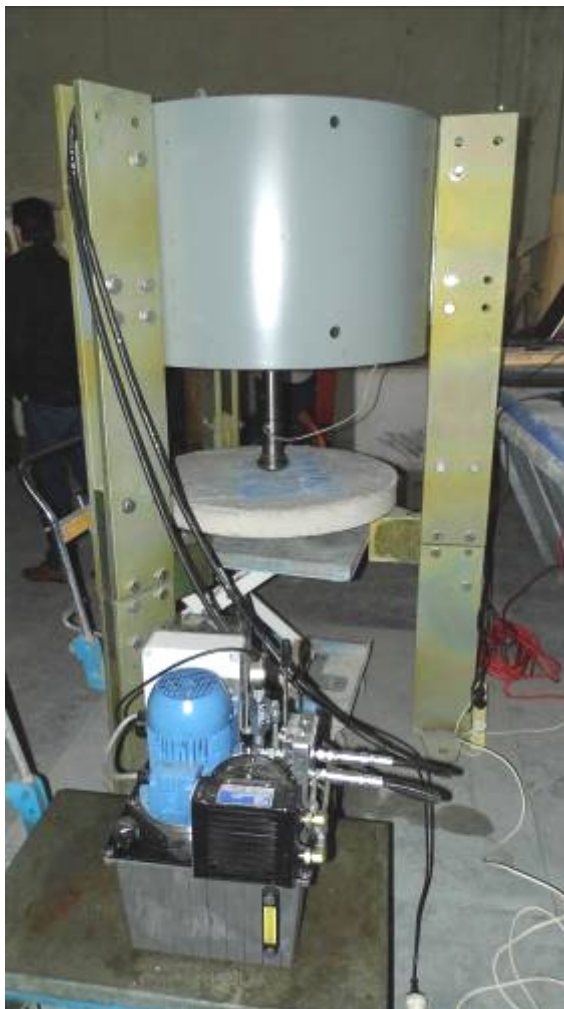
12. ábra: kör alakú panel teszt ASTM C1550 szerint (a szerző felvétele)
